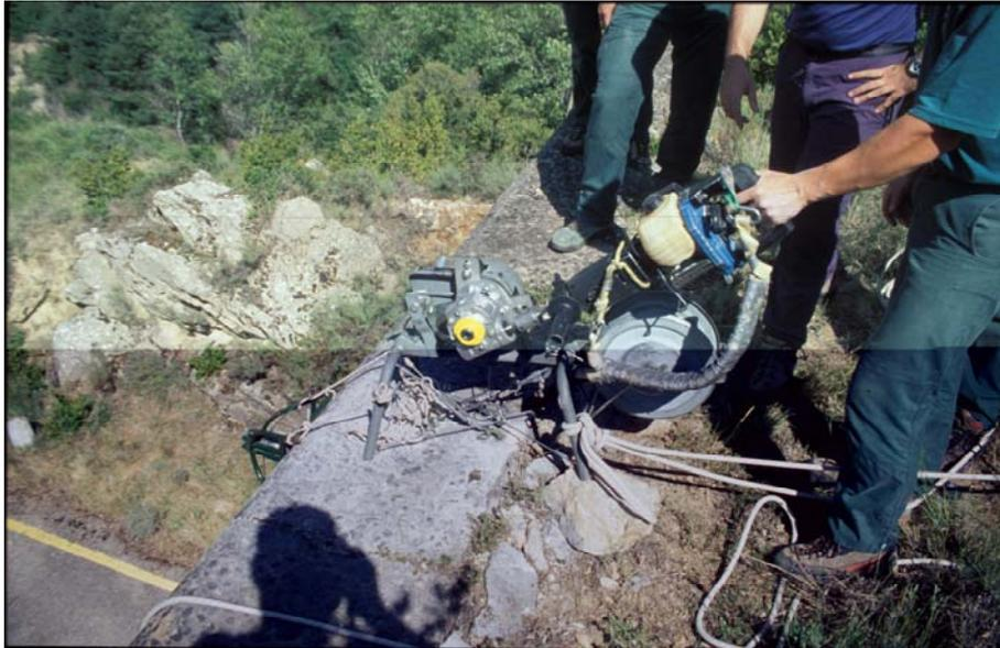
**Fotografía 5.** Torno funcionando con un taladro de gasolina.
