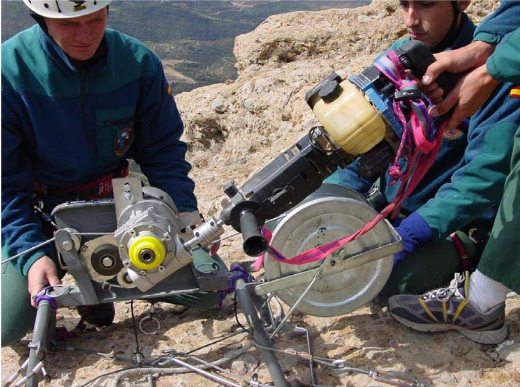
**Fotografía 11.** Visera de los Mallos de Riglos. Torno con taladro de gasolina
