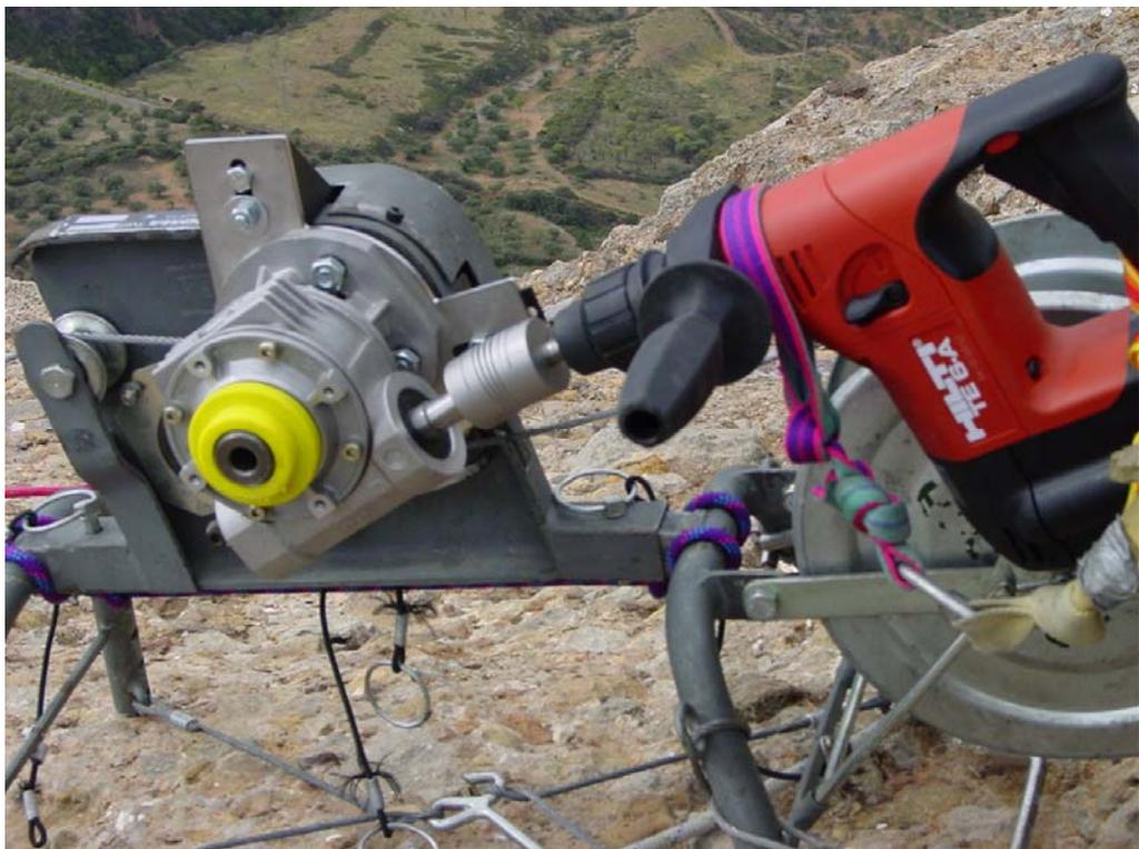
**Fotografía 10.** Visera de los Mallos de Riglos. Torno con taladro eléctrico
