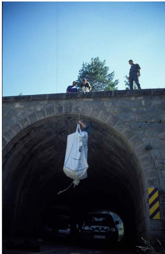
**Fotografía 8.** El dispositivo se probó elevando diferentes cargas, desde 50 Kg hasta 345 Kg.
