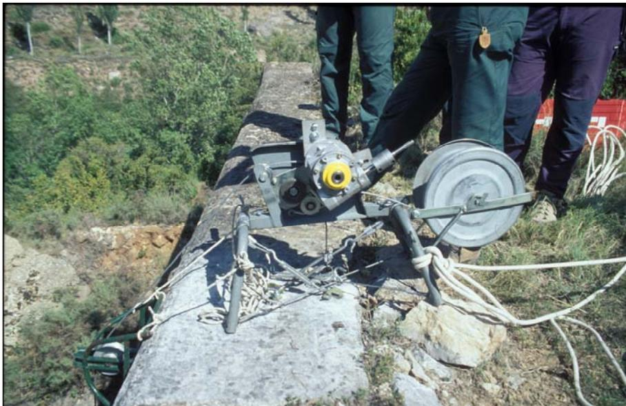
**Fotografía 4.** El torno ha sido instalado y está preparado para funcionar. En la parte posterior del torno se puede observar el carrete de cable metálico que se usa para la elevación de la carga.
