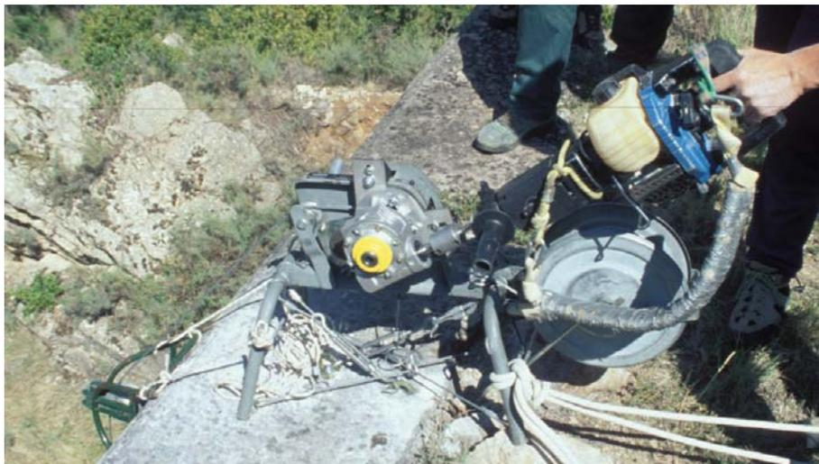
**Figura 3:** Torno de rescate POMA modificado, con el acoplamiento mecánico entre el taladro y el torno.
