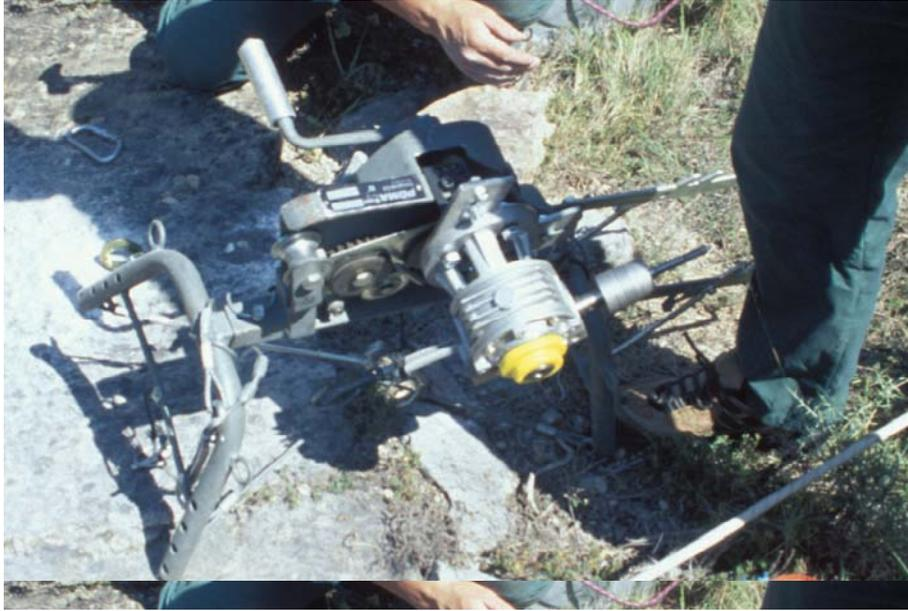
**Fotografía 3.** Detalle del torno de rescate antes de su fijación.
